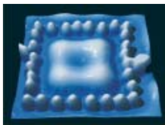
Manganatomer på silver, vid Christian-Albrechts-universitetet i Kiel. Manganatomerna bildar ett staket som stänger inne elektroner. Dessa bildar ett mönster som beror på vilken elektrisk spänning som sätts in. Sådana effekter kommer att vara viktiga för morgondagens elektronik.
