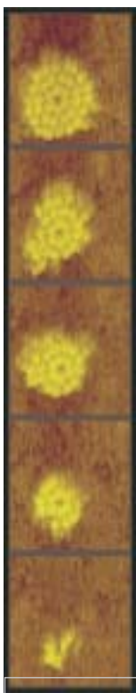
En liten kiselö på en kiselkristall smälter långsamt vid 450 grader. Kunskap om sådana processer är viktig för kvaliteten på tunna skikt.
