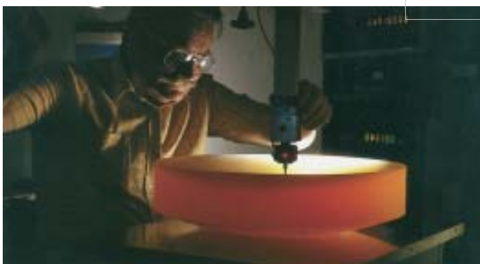
Zerodur till litografimatriser, den speciella keramiken håller stabil form till och på nanonivå.
