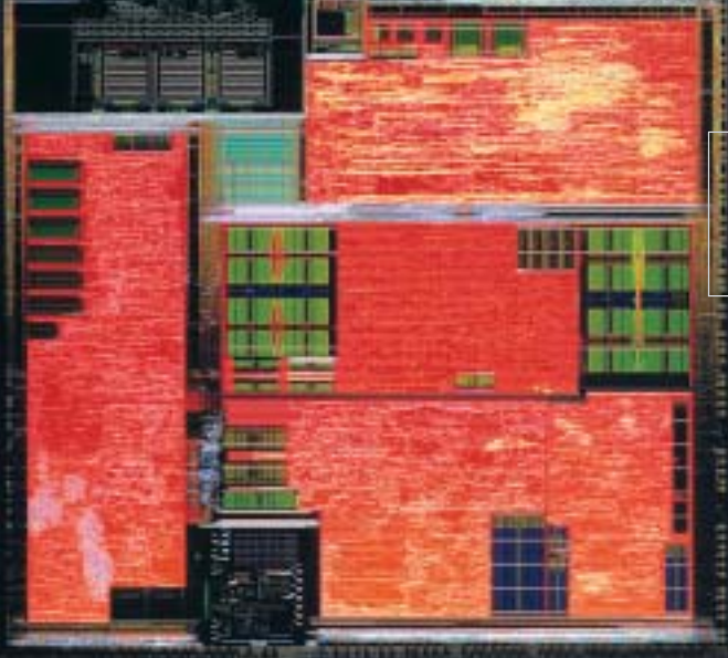
Tv-studio på en fingernagel: multimediechip medstyrsystem för bildskärmsstyrning med hög upplösning, med en energiförbrukning som en ficklampa.
