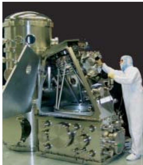
Prototyp till en anläggning för en extrem ultraviolett waferstepper för produktion av framtidens chipgenerationer.
